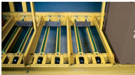
Compartimiento de batería con tope trasero ajustable.
