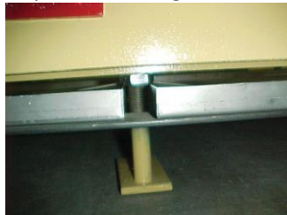
Bandeja deslizante de acero inoxidable p/derrames de electrolito
