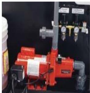
El Sistema de Reciclaje MWTS incluye una bomba de presión que está configurada para apagarse a una presión superior a 50 PSI y encenderse a una presión inferior. Las bombas están totalmente automatizadas y no requieren un tanque de presión para mantener la presión.
