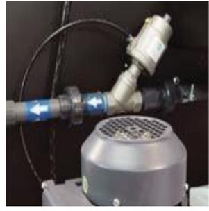
El MWTS utiliza una válvula inclinada de acero inoxidable que funciona con aire, ya que funciona bien en ambientes con escombros y materiales corrosivos.
