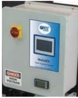
El MWTS está controlado por un PLC. El PLC monitoriza los niveles de líquido, la presión, el flujo y se ajusta en consecuencia. El MWTS incorpora una HMI (Interfaz Hombre-Máquina), que muestra advertencias y permite al usuario cambiar los ajustes y realizar diagnósticos.
