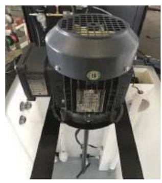
El mezclador de paletas en el tanque de tratamiento se enciende cuando el sensor de nivel de líquido superior en el tanque de tratamiento se ha levantado. La velocidad del motor mezclador es controlada por un VFD (Variador de frecuencia) y está preestablecido en 25 Hz.
