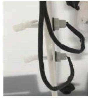
Sensores de nivel de líquido: Los sensores de nivel de líquido tipo Reed se usan en todo el sistema para monitorear los niveles de agua en los tanques. Los sensores de nivel de líquido controlan el flujo de agua que entra y sale del tanque de compensación.
