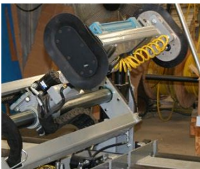
Extracción por vacío
